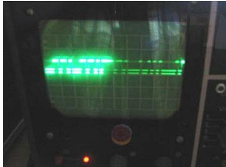
Abbildung 20: Anzeige während einer Datenverbindung mit Sende- und Empfangsdaten
