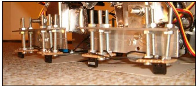
Abbildung 22: Foto der Sensoren an den Füßen
